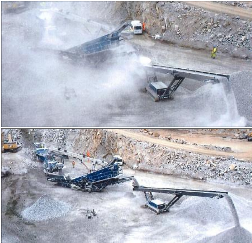
Abbildung 13: Einsatz ohne (oben) und mit Niederdrucksprühsystem (unten)
